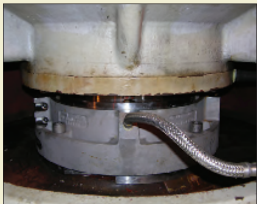
スプリット・シールの取付け、修理が機器を分解することなくできるので、時間と運転コストが節約できます。
